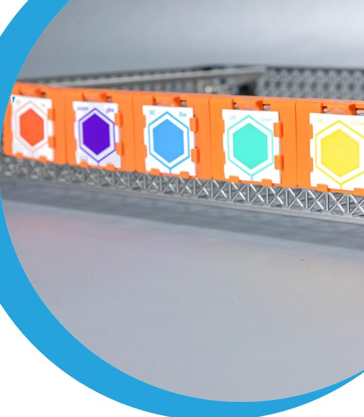
Lors d'un test, toutes les versions d'indicateurs sont utilisées dans le laveur-désinfecteur. L'indicateur qui est le dernier à être lavé dans le processus validé est le plus approprié pour la surveillance de routine. Le résultat est archivé et sert de référence pour tous les résultats des tests futurs.
